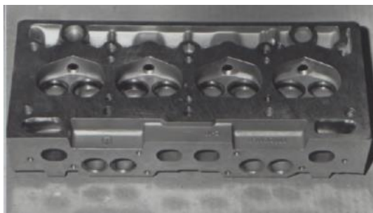
Chiulasa serie Dacia/Renault cu supape paralele (camera de ardere tip "pana") Porturi rotunde Porturi patrute
